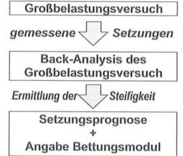
Bild 7: Untersuchungsmethodik zur Bestimmung der Setzungen und der Bettungsmodulverteilung
